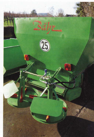
Gesteinsmehl kann mit einem kombinierten Kompoststreuer ausgebracht werden. Das im Hause Bähr konzipierte Gerät besteht aus einem konventionellen Kompoststreuer mit Kratzboden, in den eine Stahlwanne eingesetzt werden kann. In der Wanne dreht sich eine Förderschnecke, die das Gesteinsmehl auf zwei kleine Tellerstreuer aufgibt
